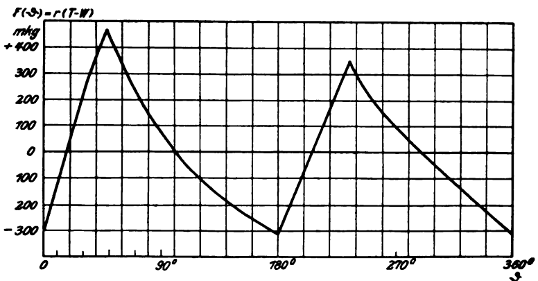
Fig. 108. Tangentialdruckdiagramm der Einzylinderdampfmaschine.
